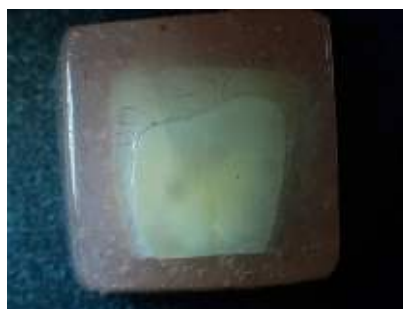
Figura VI.13 - Imaginile probelor de smalț la 36 ore și la 48 ore, fixate în rășină acrilică și pregătite pentru a testa duritatea smalțului post-expunere la \text{HNO}_3
