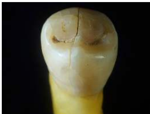
Figura V.16 - Aspectul unui dinte după 336 de ore de expunere la fumul de sudură în incinta de testare
