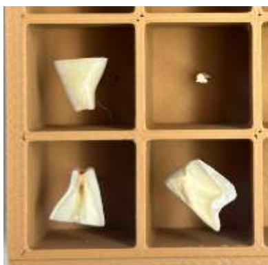
Figura V.9 - Secțiuni transversale și longitudinale ale dinților incluși în experiment, în vederea obținerii probelor pentru testare
