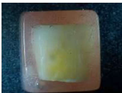
Figura VI.13 - Imaginile probelor de smalț la 36 ore și la 48 ore, fixate în rășină acrilică și pregătite pentru a testa duritatea smalțului post-expunere la \text{HNO}_3
