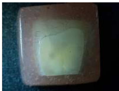
Figura VI.12 - Imaginile probelor de smalț la 12 ore și la 24 ore, fixate în rășină acrilică și pregătite pentru a testa duritatea smalțului post-expunere la \text{HNO}_3
