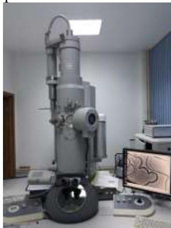
Figura 1 Microscopul electronic Tecnai T12 produs de FEI , care se găsește la Facultatea de Medicină a Universității “Ovidius” din Constanța
