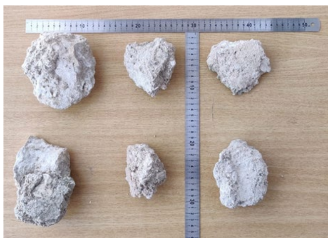
Figura 10 Mostrele de mortar neprelucrate
