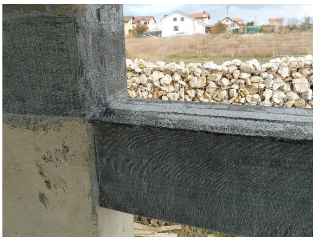
Fig. 4.8 Nodul 2 experimental – dreapta (zona 3 de încercare)
