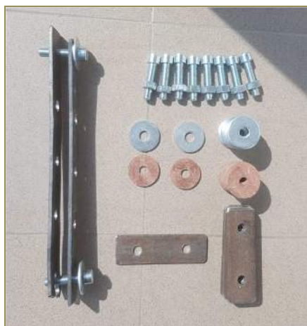
Figura 4.2.1 Elemente componente ale amortizorului cu frecare prin rotație
