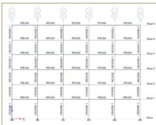
Figura 5.2.1 Structură necontravântuită (SMNC)
