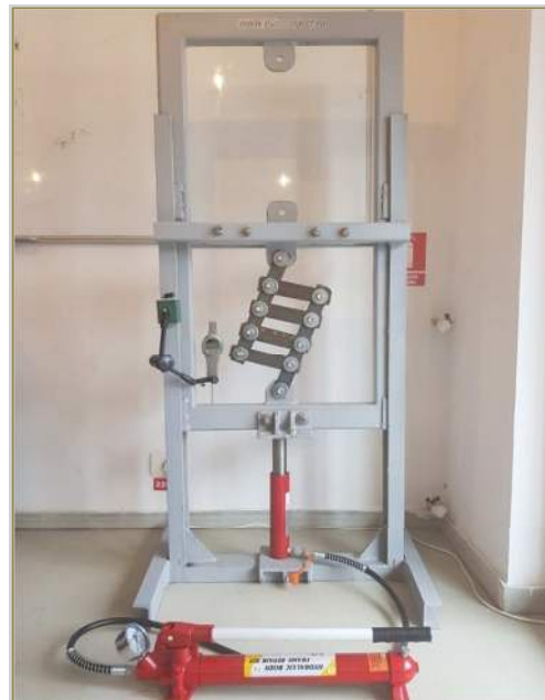
Figura 4.1.2 Mașina de testare universală
