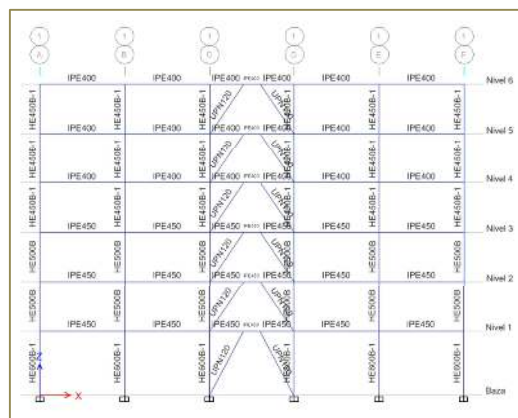
Figura 5.2.3 Structură metalică contravântuită excentric (SMCE)
