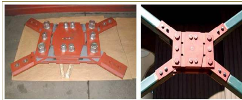
Figure 3.1.2 „Pall-type friction damper a) în laborator, b) instalat” (Pall, 2006)
