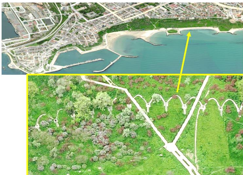
Figura 4.6 – Lucrari de stabilizare taluz, faleza de E, realizate de IPTANA Bucuresti intre anii 1956-1957 – imagini google maps – satelit
