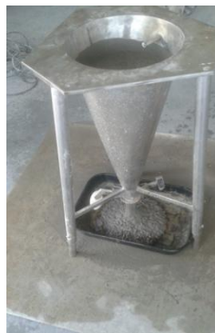
Fig.4.4-Testul O' Funel pentru beton autocompactant(foto autor)
