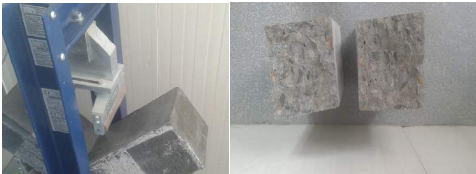
Fig.4.17,4.18- Determinarea rezistenței la întindere din încovoiere în cazul BAC
