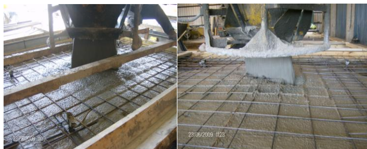
Fig.1.15,1.16-Fabrică realizare prefabricate din beton autocompactant, Leicester, Marea Britanie(foto autor)
