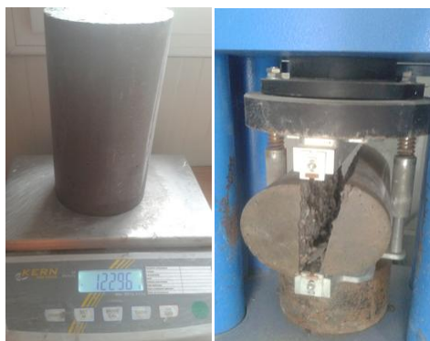
Fig.4.21,4.22- Determinarea rezistenței la întindere din despicare în cazul BAC
