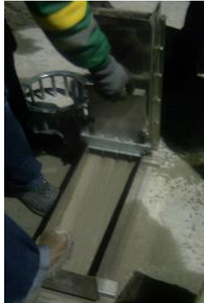
Fig.4.5-Testul Cutia L pentru betonul autocompactant(foto autor)
