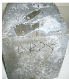
Fig.3.12-Beton supus atacului sulfatic, probă laborator(foto autor)
