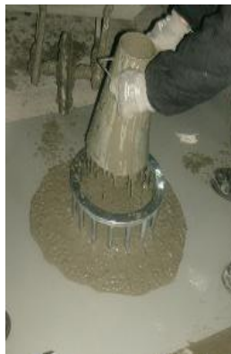
Fig.4.6-Testul inel J pentru beton autocompactant(foto autor)
