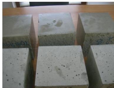
Fig.2.11- Porozitatea betonului vibrat normal comparativ cu porozitatea betonului autocompactant-teste laborator(foto autor)
