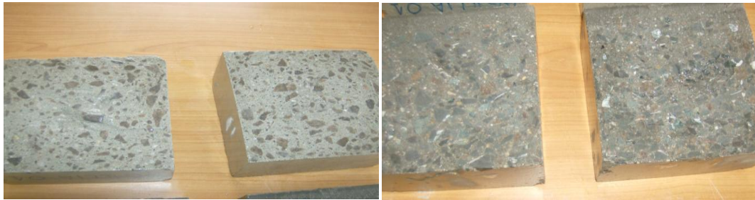
Fig.2.17,18-Distribuția agregatelor în beton în cazul betonului autocompactant comparativ cu betonul vibrat normal,-test laborator(foto autor)
