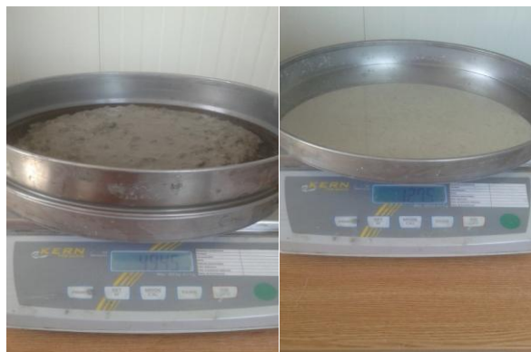
Fig.4.7,4.8-Determinarea rezistenței la segregare utilizând site(foto autor)
