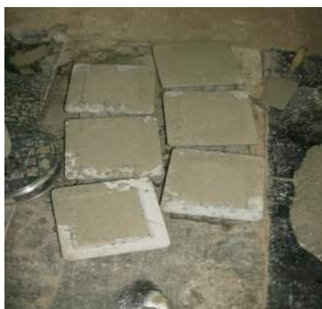
Fig.4.9-Confecționarea epruvetelor din beton(foto autor)
