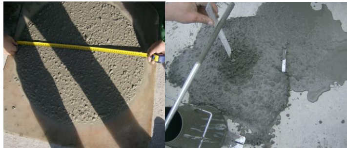
Fig.4.1,4.2-Efectuarea testului de răspândire a betonului autocompactant comparativ cu efectuarea tasării la un beton fluid(foto autor)
