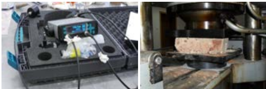
Fig. 4.29 - Încercarea distructivă la compresiune – (foto autor)
