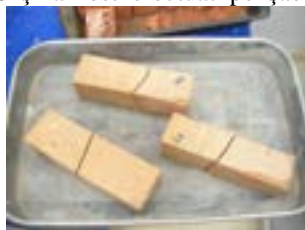
Fig. 5.52 – Epruvete de cărămidă încercate la încovoiere – (foto autor)
