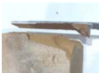
Fig. 4.67 - Detașarea fâșiilor CFRP de cărămizi – (foto autor)
