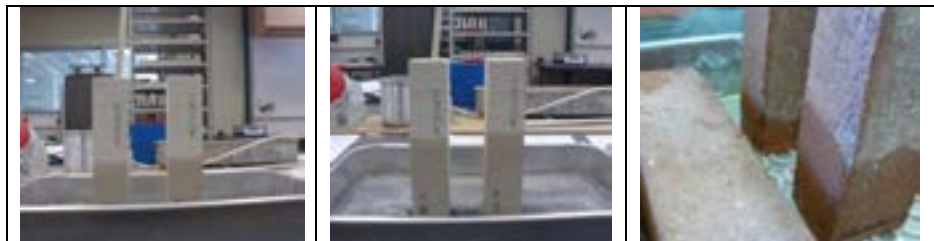
Fig. 5.43 - Testul de absorbție prin capilaritate la mortare și cărămizi – (foto autor)
