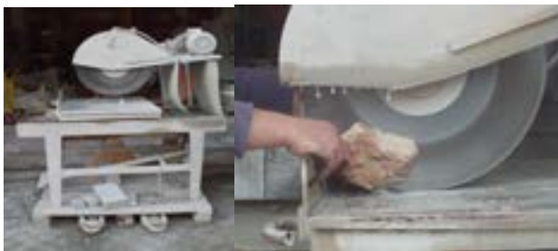
Fig. 3.23. Echipamentul utilizat pentru tăierea blocurilor de piatră și realizarea epruvetelor
