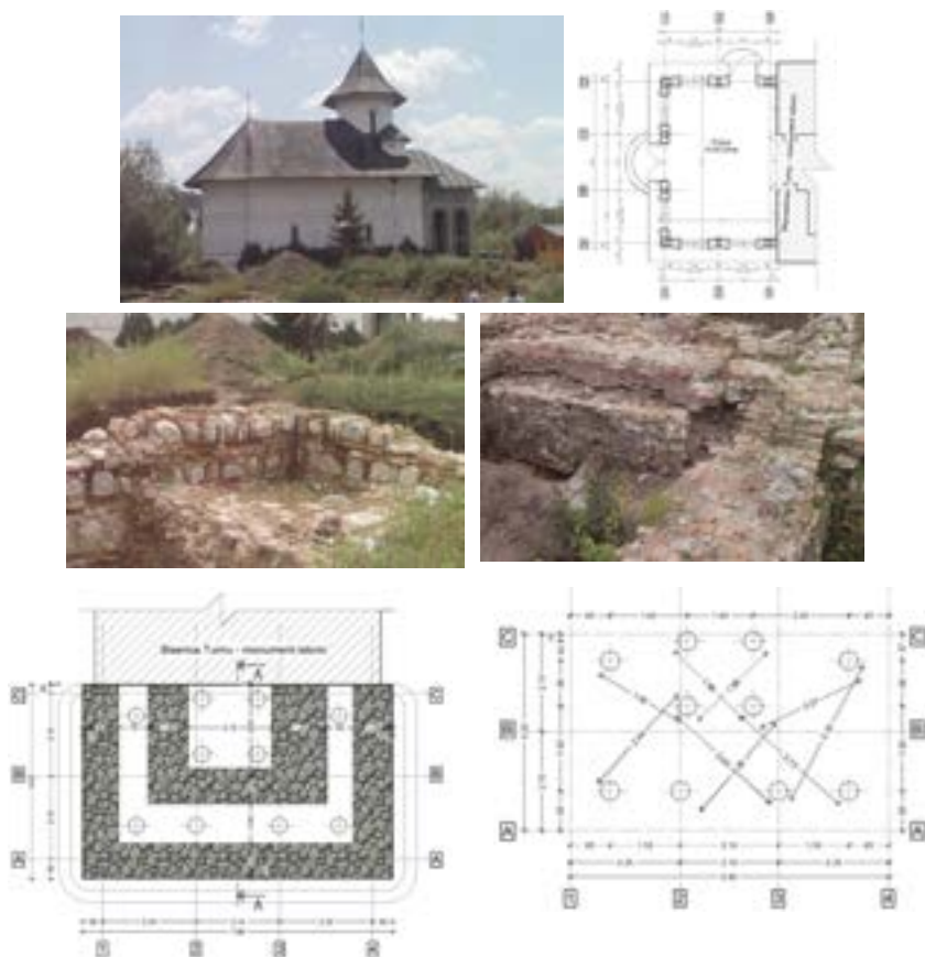
Fig. 2.126. a. Plan amplasare ziduri istorice existente – b. Plan trasare piloți
